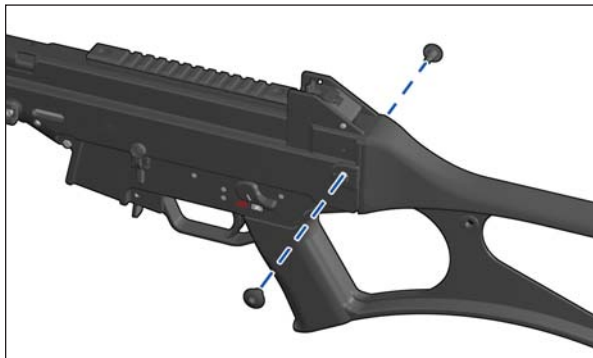
Abb. 38a: Schrauben lösen
