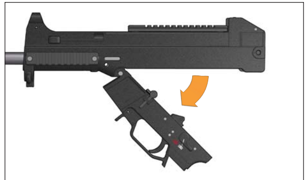
Abb. 38b: Abzugskasten nach unten klappen
