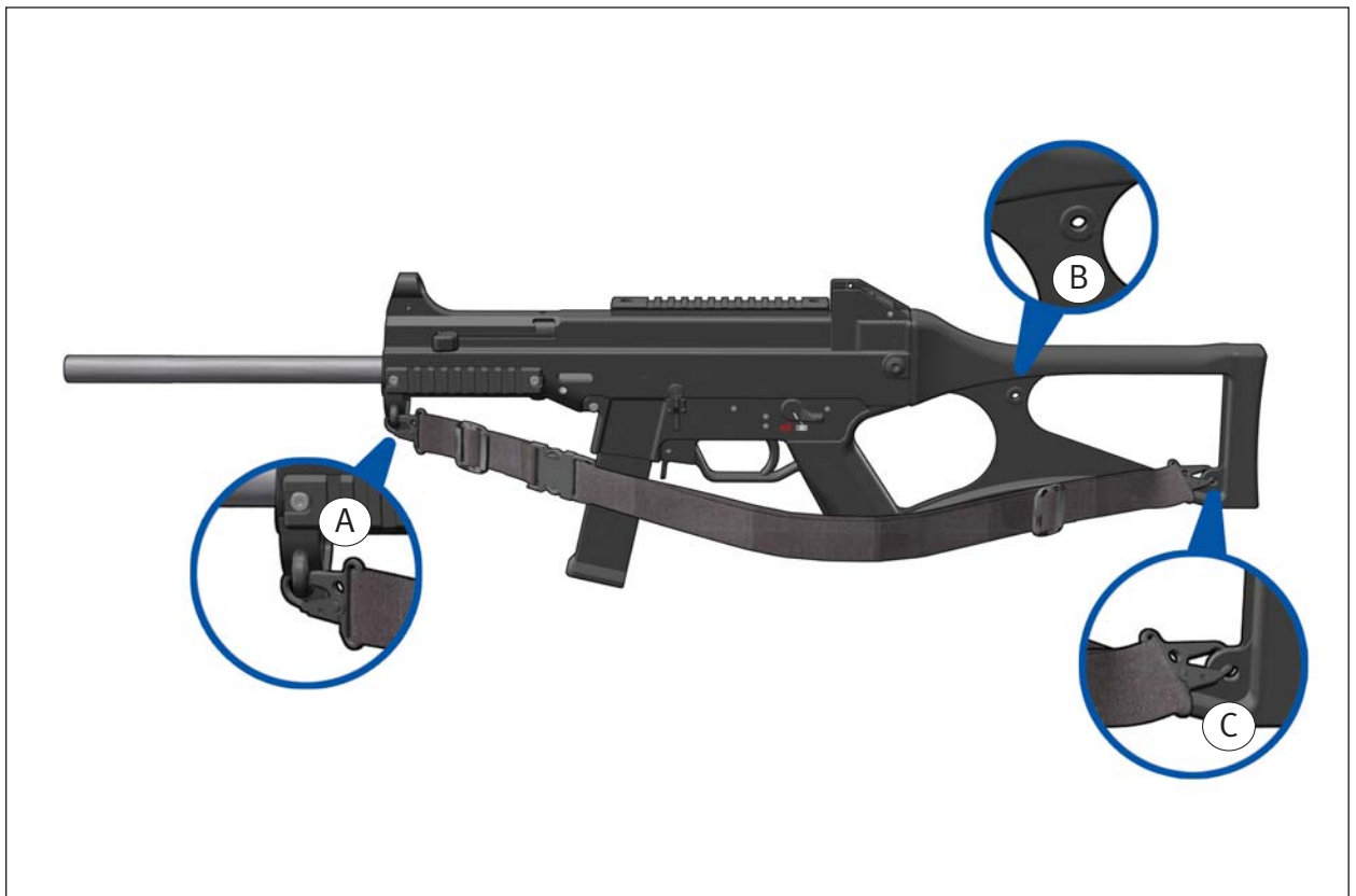
Abb. 24a: Trageriemen an die Waffe montieren
