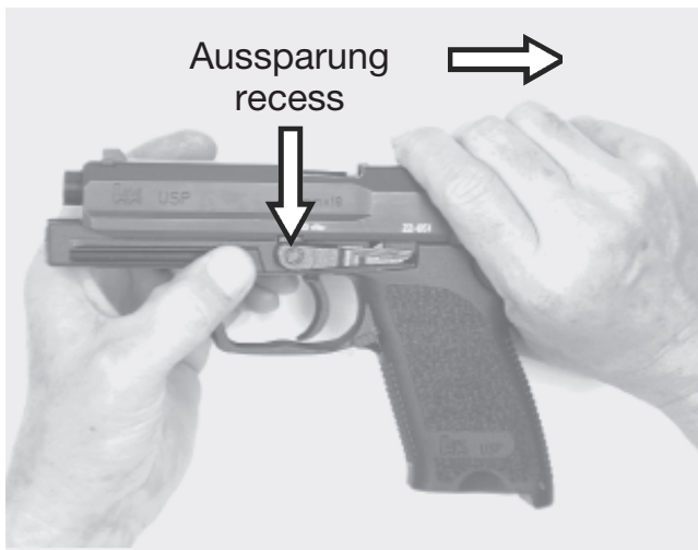
Lage Aussparung zum Verschlussfanghebel Position of the recess of the slide release
