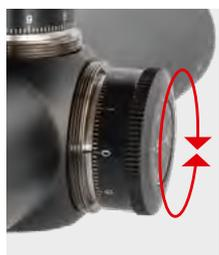
Befindet sich Ihr TP links vom Zielpunkt (ZP), müssen Sie die Seiteneinstellung gegen den Uhrzeigersinn in Richtung „R“ drehen, um den TP nach rechts zu verschieben.
