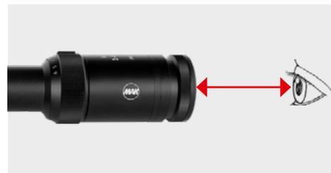
Lösen Sie die Ringe der Zielfernrohrmontage leicht und versetzen Sie das Zielfernrohr soweit nach vorne wie es gerade noch montierbar ist. Wählen Sie die stärkste Vergrößerung. Befestigen Sie das Zielfernrohr in einer komfortablen und wiederholbaren natürlichen Stellung. Schieben Sie das Zielfernrohr soweit rückwärts bis das Sehfeld in Ihrem Zielfernrohr maximal groß ist.
