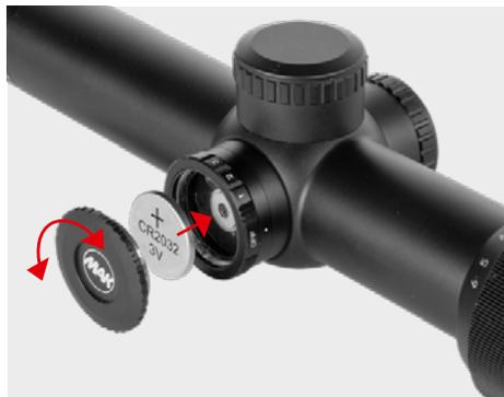
MAKpro-Zielfernrohre sind mit beleuchtetem Absehen ausgestattet und benötigen CR2032-Batterien. Zum Einlegen der Batterie lösen Sie die Batteriefachabdeckung auf der linken Seite des Verstellturms am Zielfernrohr. Fügen Sie die Batterie so in das Batteriefach ein, dass der Pluspol nach außen zeigt. Schrauben Sie die Batteriefachabdeckung wieder auf der linken Seite des Verstellturms fest.
