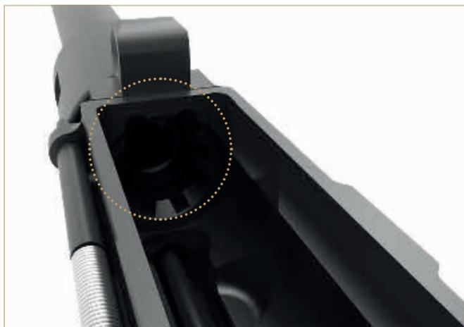
6. Schmauchrückstände im Obergehäuse mit der Bürste entfernen
