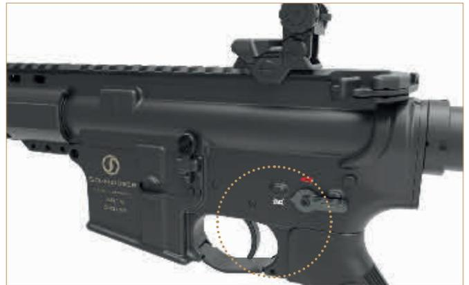
3. Sicherungshebel auf Position
