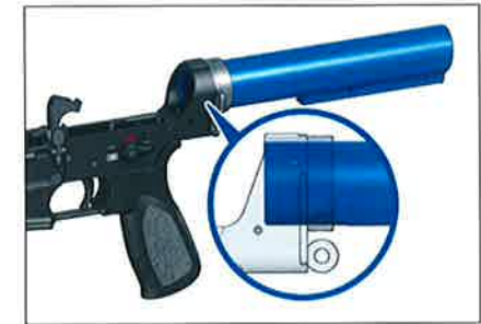
Abb. 13c: Position der Verlängerung
