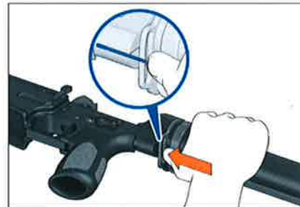
Abb. 12c: Bohrung für Raststift für Haltebolzen mit dem Finger sichern
