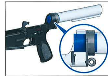
Abb. 15b: Rundmaterial in Verlängerung einsetzen
