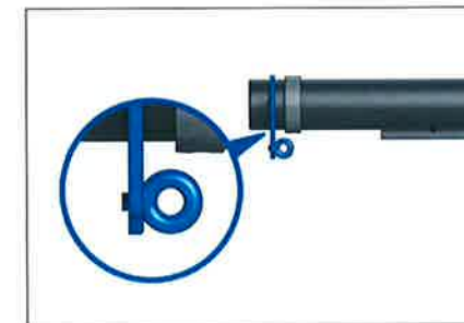
Abb. 13b: Platte auf Verlängerung schieben
