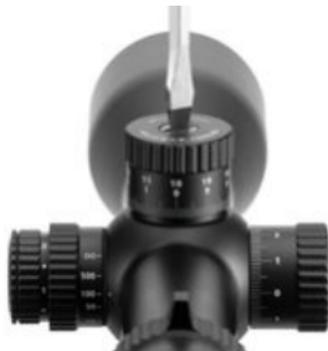
7. Drehen Sie nun die Null deckungsgleich zur Strichmarkierung und halten Sie den Turm fest, während Sie mit dem Schlitzschraubendreher die Befestigungsschraube wieder im Uhrzeigersinn festschrauben. Ziehen Sie sie nicht zu fest an.
