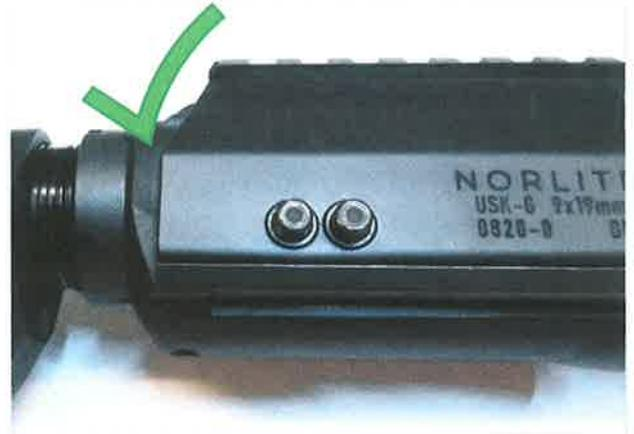
Eine falsche Montage führt dazu, dass der Verschlussträger beim ersten Schuss im Rücklauf den vorderen Zerlegebolzen beschädigt. Dabei kann es auch zu einer Beschädigung des Gehäuses kommen, welche den Ersatz des Gehäuses notwendig macht.
