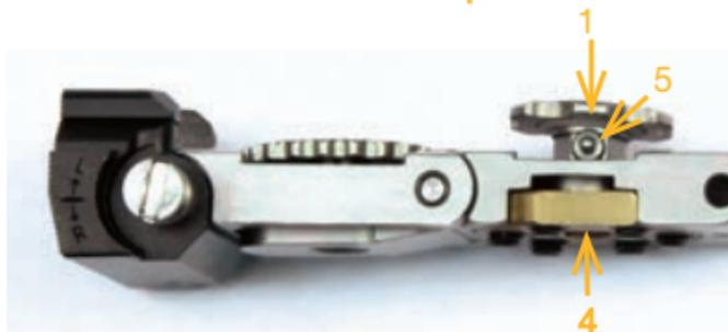
Nach dem Ausbau des Einstellrades 1 lassen sich dann der Kugelzylinder 5 und die Feder 6 entnehmen.
