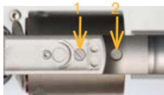
Prüfen Sie, ob die Schrauben auf der anderen Seite bündig mit dem Waffenrahmen abschließen.
