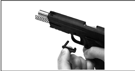
Abb. 11, Entfernen des Verschlussfanghebels
