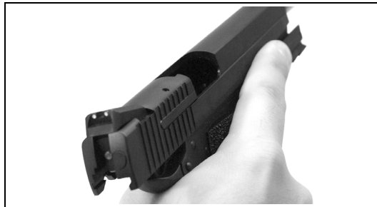
Abb. 6, Visuelle Kontrolle des Patronenlagers
