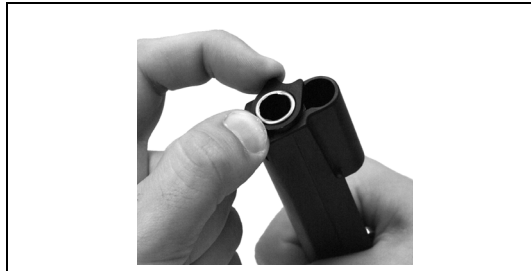
Abb. 13, Abnehmen der Laufbuchse vom Verschluss
