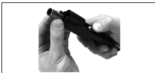
Abb. 17, Einsetzen des Laufs in den Verschluss
