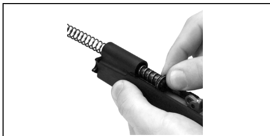
Abb. 18, Einsetzen der Schließfeder und Schließfederführung in den Verschluss
