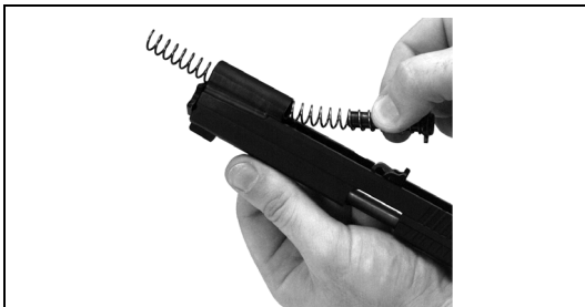
Abb. 12, Entfernen der Schließfeder und der Schließfederführung
