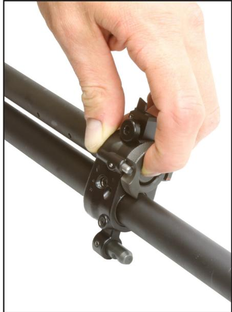
**Bild 44: Gasstange einbauen**
