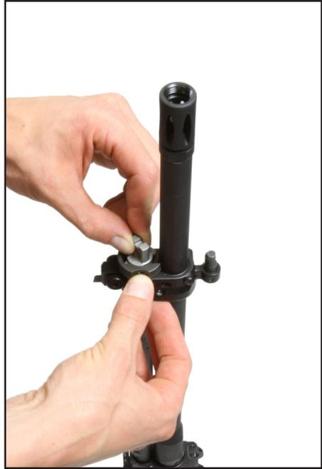
**Bild 45: Gasdüse einbauen**
