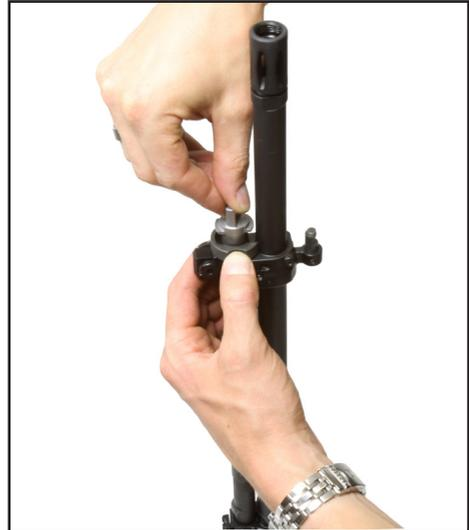
**Bild 37: Gasdüse ausbauen**
