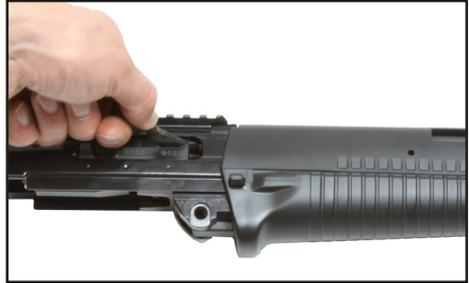
**Bild 33: Verschluss mit Ladegriff nach hinten ziehen**
