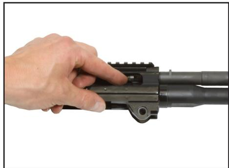
**Bild 38: Gasstange hinausschieben**
