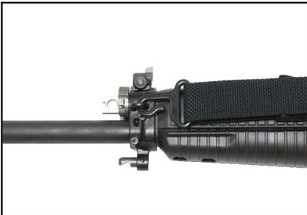
**Bild 27: Einhängen des Tragriemens am Kornträger**
