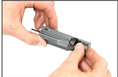
**Bild 34: Verschlusskopf herausdrehen**
