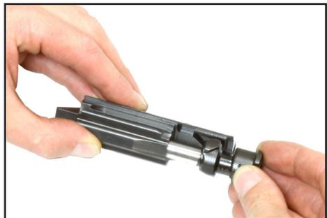
**Bild 35: Verschlusskopf herausziehen**
