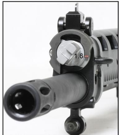
Bild 22: Gasdüsenstellung II
