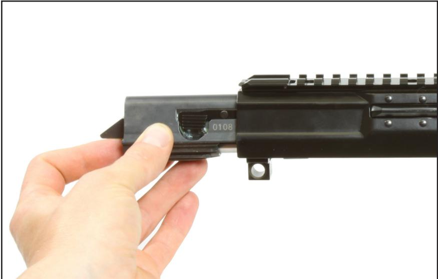
**Bild 46: Verschluss einsetzen**
