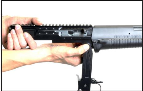
**Bild 31: Abzugvorrichtung entfernen**
